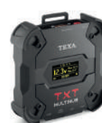
Tester diagnostyczny Navigator TXT MULTIHUB IDC5 CAR light
